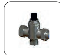
Противоожоговый клапан (сливает воду температурой выше 35 град. С)
